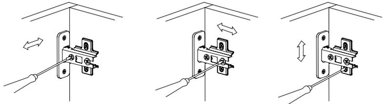
Регулировка вперед-назад. Регулируется крепежным винтом
